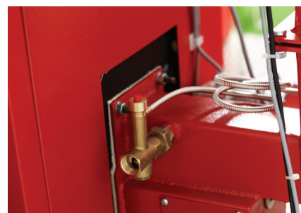
Typická montáž ventilu BVTs při použití jako ochrany proti hoření v přívodu paliva
